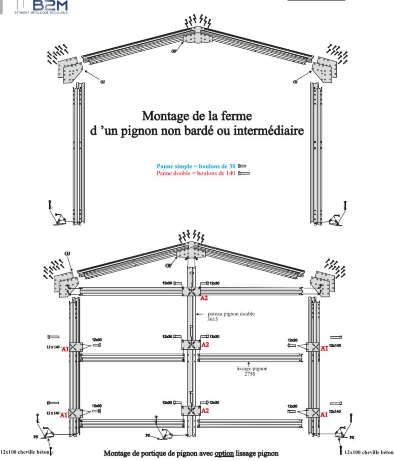
Les poteaux et les fermes sont des pannes doublées, les pièces fixées sur ces pannes doubles utilisent des boulons de 12 x 140.
