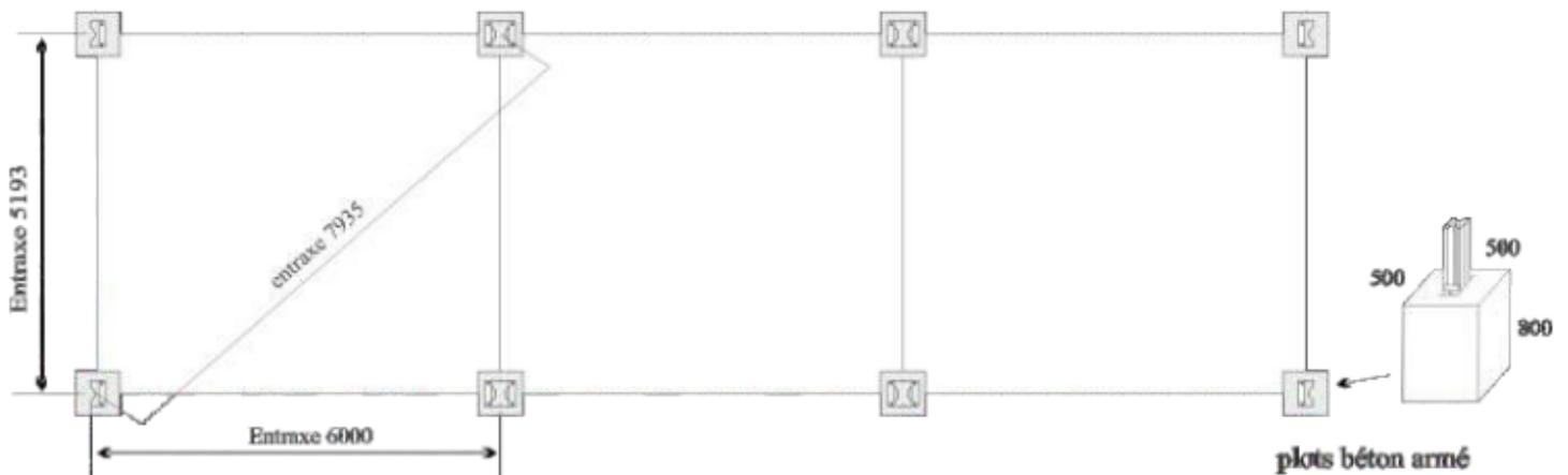
Si un portail doit être installé sur le pignon ou le long pan, prévoir une longrine de 300/200 sur une longueur de 2 fois le vantail
